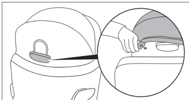
ヘッドレストの裏側にあるスナップボタンをはずします。(合計2箇所)
