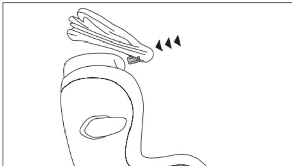
P27を参照して、ヘッドレスト一番高い位置に調節します。キャンピーの左右にあるジョイントパーツをヘッドレストのジョイント部分にカチッと音がするまで差し込みます。取りつけた後に外れないことを必ず確認してください。
