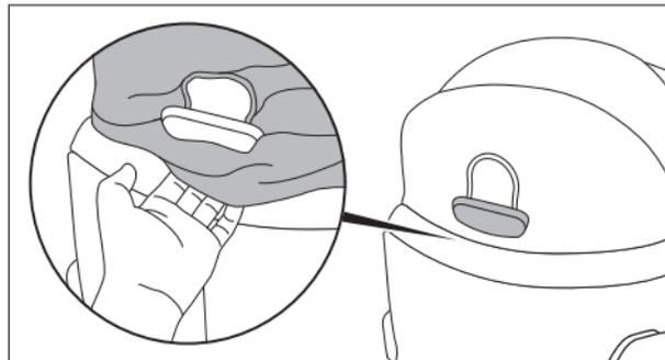
キャンピーのファブリックをヘッドレスト調節レバーに、上図の通り引っかけ固定します。
