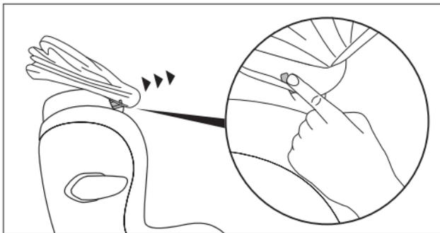
キャノピーのジョイントパーツにあるツメを押しながら手前に引き、取りはずします。(左右2箇所)
